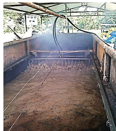
Рис. 1. Применение технологии биоремедиации и рекультивации нефтезагрязненных грунтов и нефтешламов в бассейне реки Амазонки на территории Эквадора [10]
