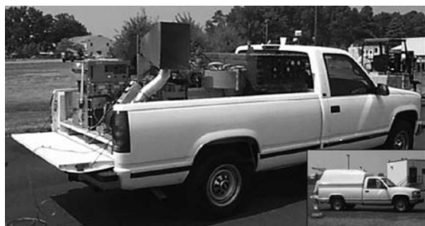
Рис. 2. Источник направленного сверхвысоко-частотного излучения, смонтированный в пикапе на базе легковушки с пластмассовым кузовом
