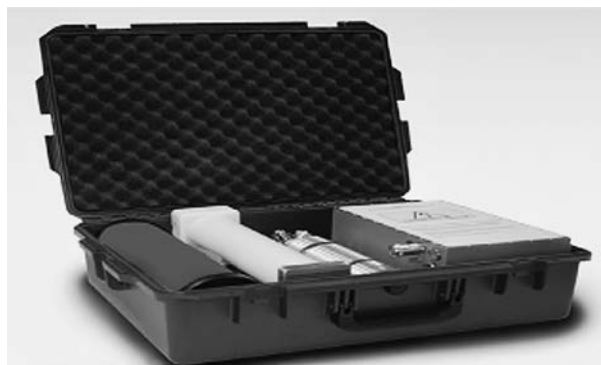
Рис. 3. Походный разрушитель электроники под названием 2100 Series Suitcase на основе генератора Маркса, производимый компанией Applied Physical Electronics
