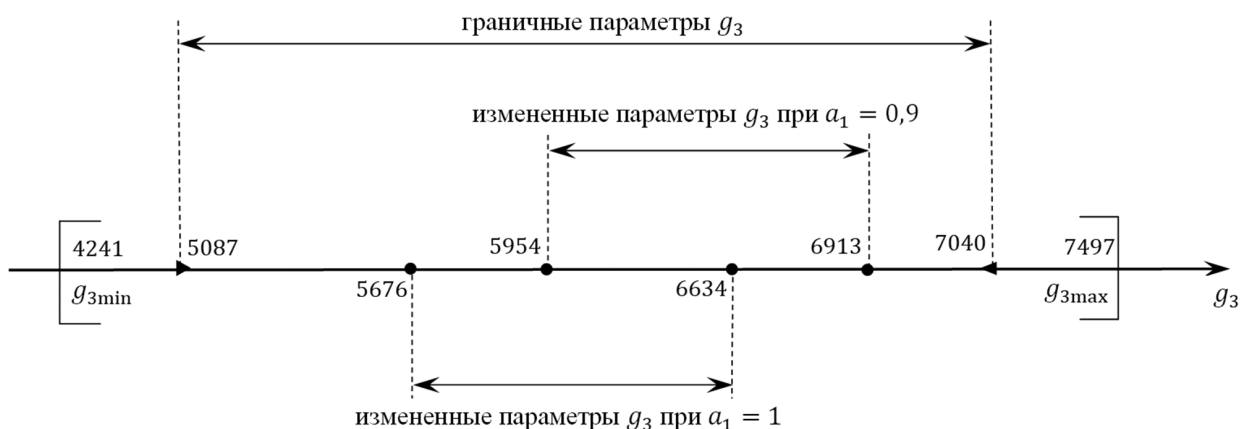
Рис. 2. Пример графического представление системы ограничений для функции оценки вероятности возникновения заторного наводнения. g_3 — расход воды в створе, a_1 — относительная величина, характеризующая наличие мостового перехода
