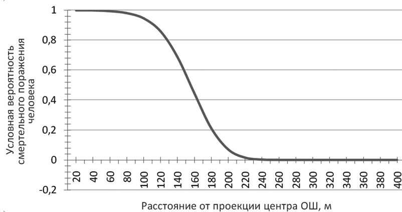
Рис. 3. Зависимость от расстояния условной вероятности смертельного поражения человека тепловым излучением огненного шара
