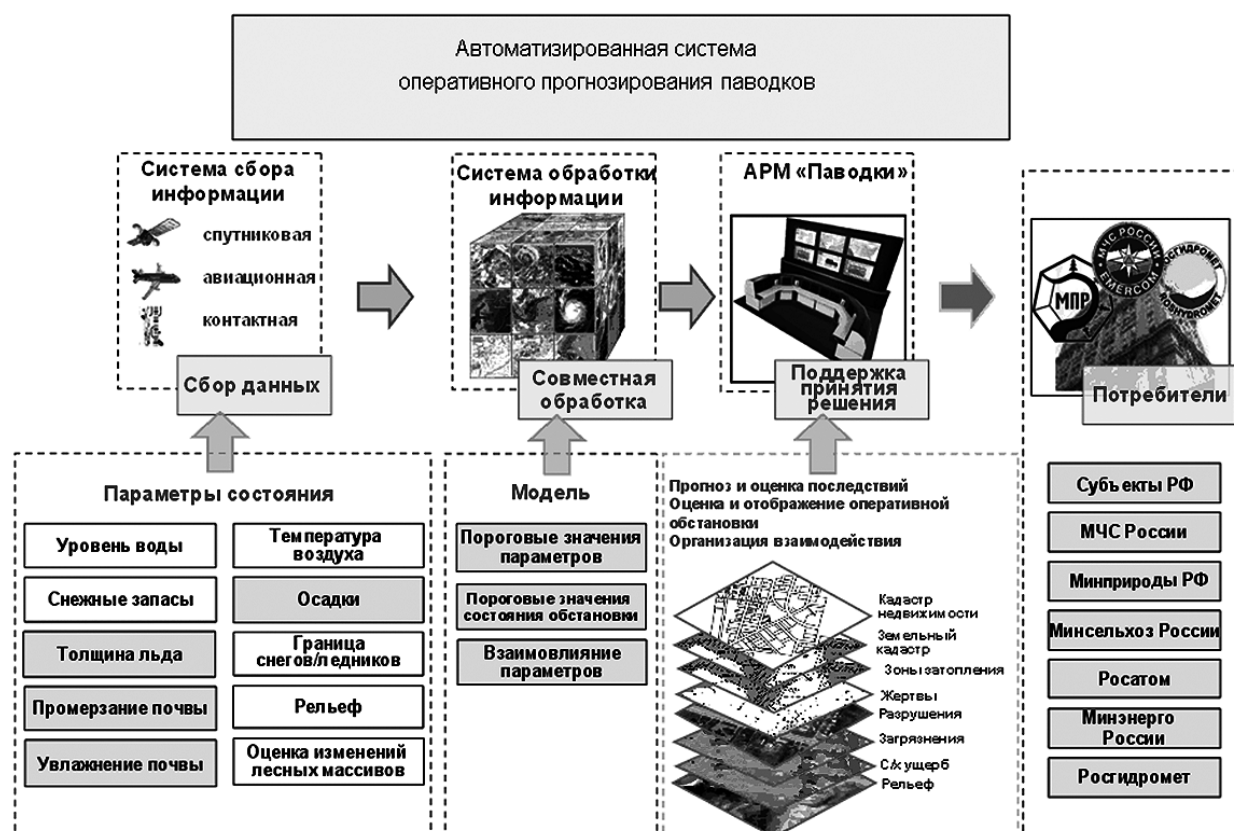
Рис. 1. Автоматизированная система прогнозирования паводковой обстановки
