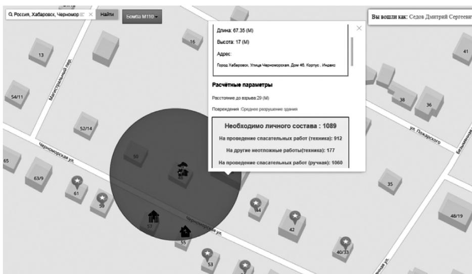
Рис. 5. Отображение степени разрушения объектов в рабочем окне программы
