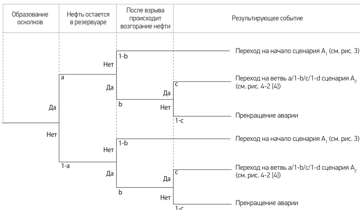
Рис. 4. Дерево событий при взрыве внутри наземного резервуара (сценарий  $A_3$ ) [4]
