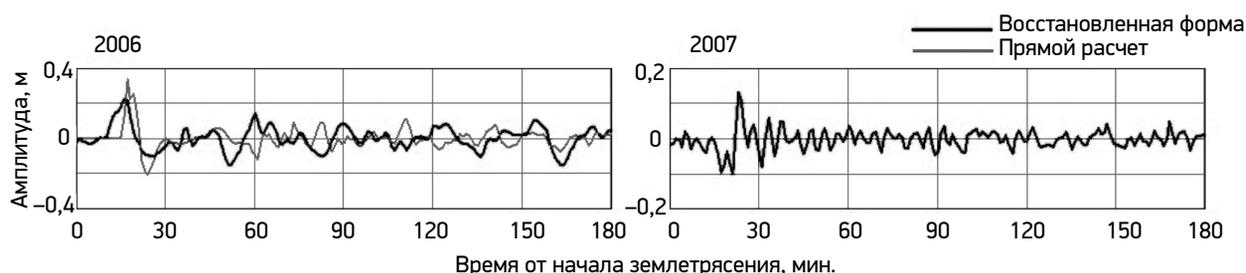
Рис. 2. Восстановленная волновая форма и форма, полученная прямым расчетом, цунами 2006 и 2007 гг. на станции DART 21419
