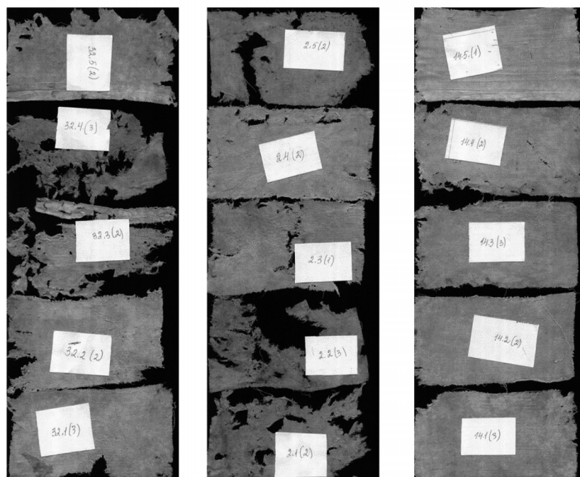
Рис. 4. Степень разрушения хлопкового материала в образцах зональной серой лесной почвы, помещенных в контейнерах в различных микрорайонах г. Пушкино (5-кратная повторность)
