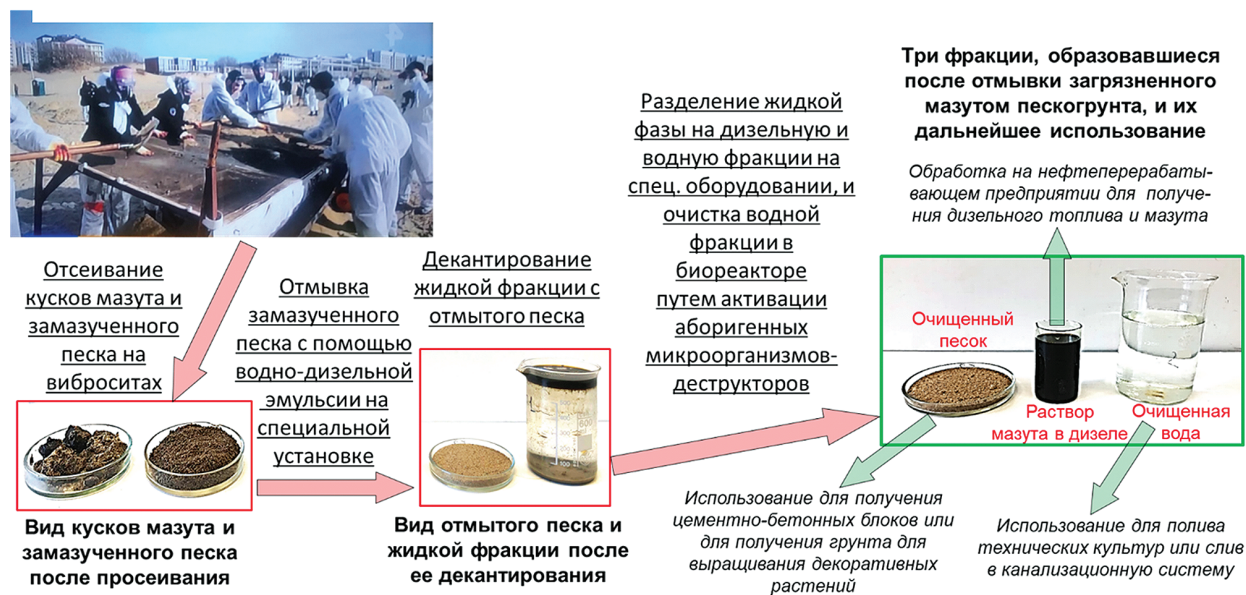
Рис. 2. Схематическое изображение биогеохимической технологии очистки загрязненного мазутом грунта для управления экологическими рисками
