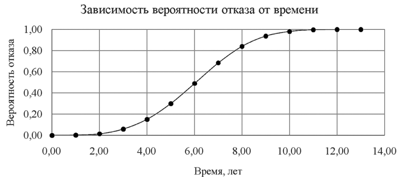
Рис. 2. Зависимость вероятности отказа пучка теплообменника от времени эксплуатации
