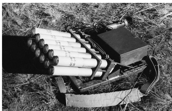
Рис. 7. Модернизированная пусковая установка ПУ-ЗДП-М с зажигательно-дымовыми патронами ЗДП-2, обеспечивает противодействие в видимой и инфракрасной области спектра
