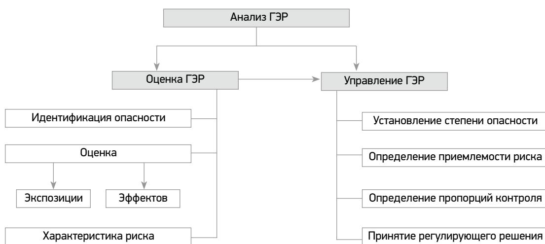
Рисунок. Схема анализа ГЭР кислотообразующих выпадений в зонах влияния объектов нефтегазовой промышленности в Российской Арктике (составлена по материалам [14])
