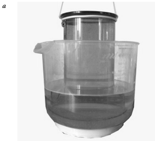
Рис. 3. Эксперимент, подтверждающий эффект парадокса гидростатики
