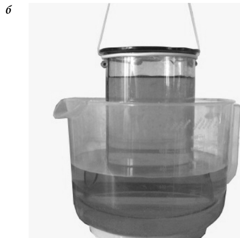
Рис. 3. Эксперимент, подтверждающий эффект парадокса гидростатики
