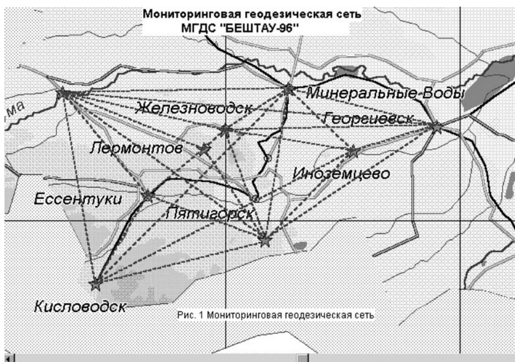
Рис. 1. Геодинамическая сеть «Бештау» по мониторингу сейсмической активности территории
